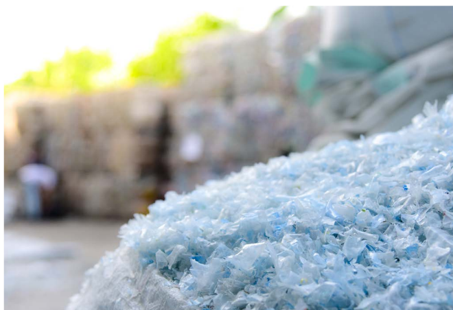
Fig 2. Immagine di plastica PET sminuzzata, che viene poi fusa e riutilizzata per produrre oggetti riciclati
